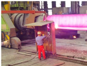
Arbeiten an der Freiformpresse
